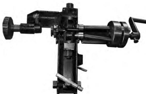
Рис. 9. Аппарат для накатки резьбы «Лавром». Авторы Лавров А.В. и Романов В.В.
